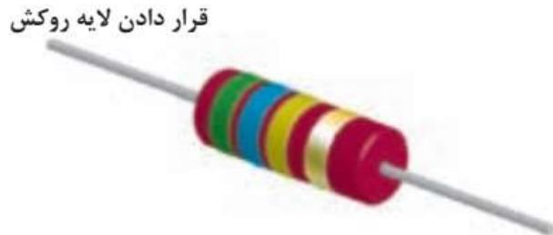
شکل ۳-۴۲- مراحل ساخت مقاومت توده کربنی
